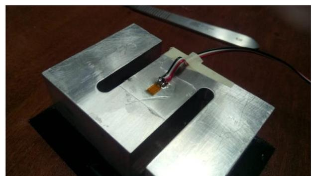
**Figura 16** Galga posicionada para obtener lecturas en el eje Y
